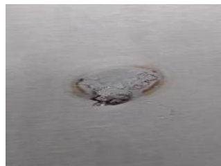
Gambar 1. Cacat Pengelasan Pada Carbody Kereta Stainless Steel
