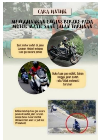
Gambar 2. Poster cara menggunakan engine brake pada motor matic saat jalan turunan
